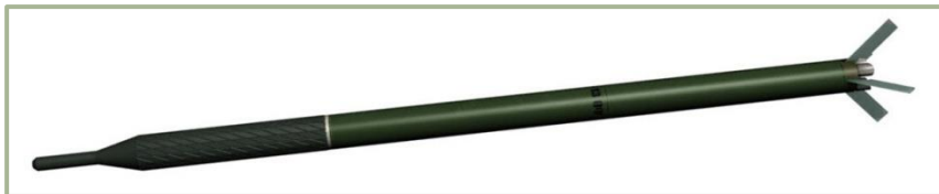
3-11: Неуправляемая авиационная ракета С-130Ф
