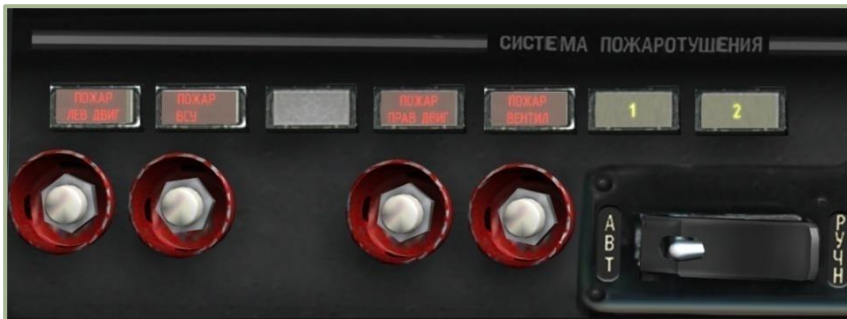
10-19: Панель управления системами пожаротушения
