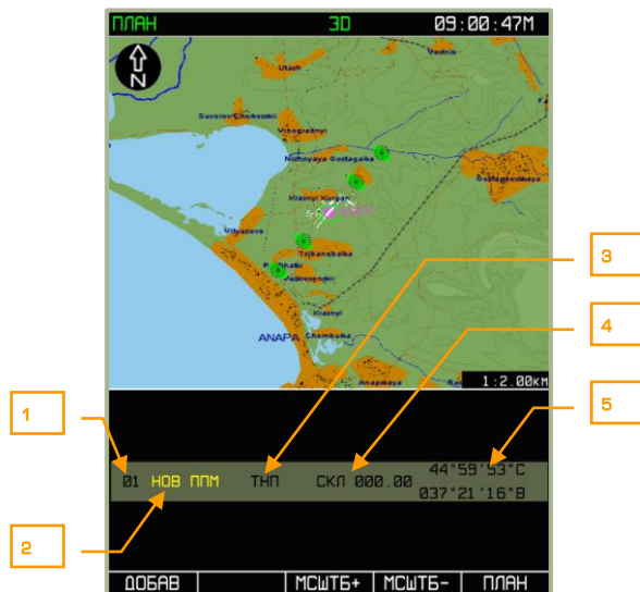
7-46: Исходное состояние дисплея при вводе первого ППМ плана полета
