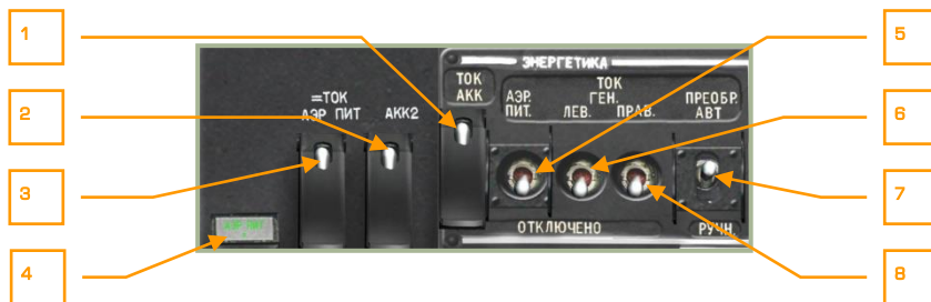
6-52: Пульт первый боковой, панель ЭНЕРГЕТИКА
