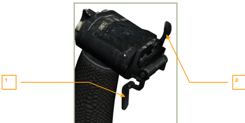
6-7: Гашетки РС и ВПУ в положении ОГОНЬ ВПУ (гашетка РС откинута вверх)
