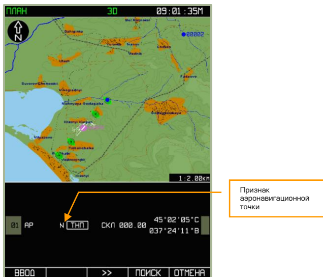
7-48: Вид дисплея при вводе ППМ, когда под активным маркером на поле карты есть аэронавигационная точка
