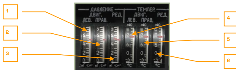
6-57: Пульт правый боковой, панель индикаторов давления, температуры масла двигателей и редуктора
