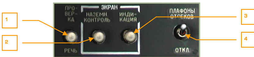
6-67: Пульт контроля системы ЭКРАН, кнопка проверки речевого информатора АЛМАЗ, выключатель плафонов отсеков
