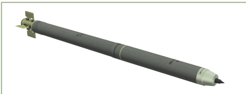
3-7: Неуправляемая авиационная ракета С-8ОФП2 (С-8М)
