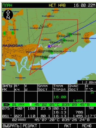
7-78: Вид дисплея перед активизацией подготовленного (загруженного) плана полета
