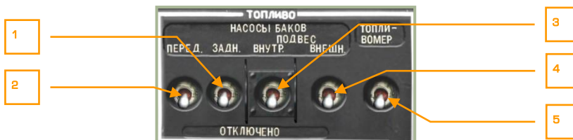
6-54: Пульта правый боковой, панель управления топливными насосами
