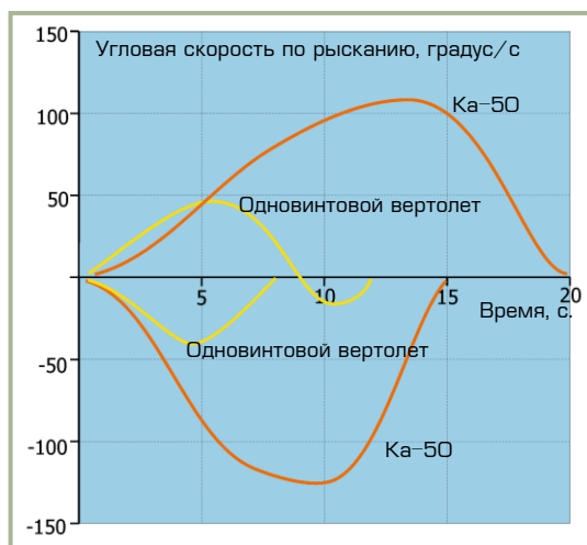
5-6: Угловая скорость вращения вертолѣта относительно вертикальной оси на режиме висения
