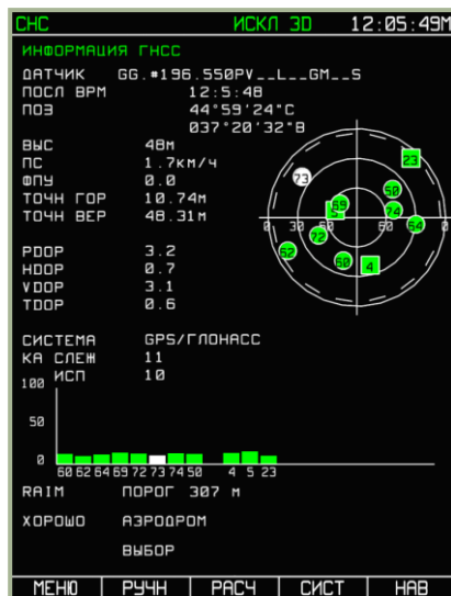
7-31: Вид дисплея при исключении из расчетов данных спутника № 73
