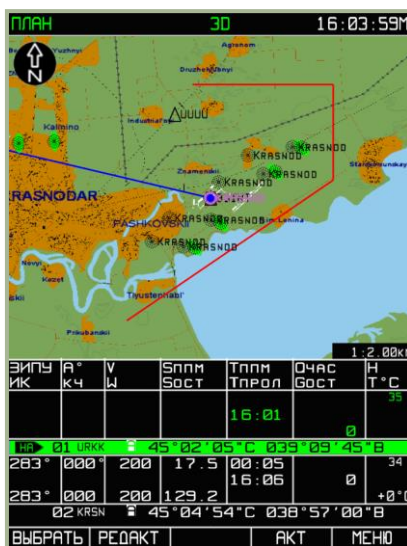
7-81: Вид дисплея после загрузки плана полета
