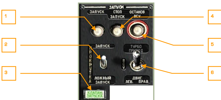
6-76: Панель управления запуском двигателей
