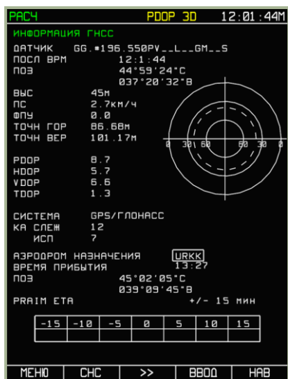
7-33: Автоматическая подготовка данных для просмотра альманаха и выполнения расчетов на аэропорт прибытия
