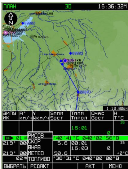
7-83: Выбор функции РИСОВАНИЕ для входа в режим изменения параметров элементов маршрута
