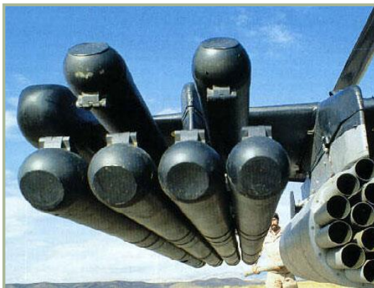
1-5: Противотанковые ракеты «Вихрь» на пусковой установке АПУ-6
