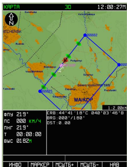
7-21: Вид дисплея при активизации функции МЕРИТЬ
