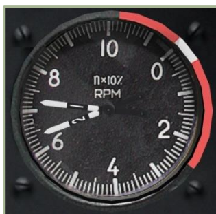
6-26: Сдвоенный указатель частоты вращения двигателей
