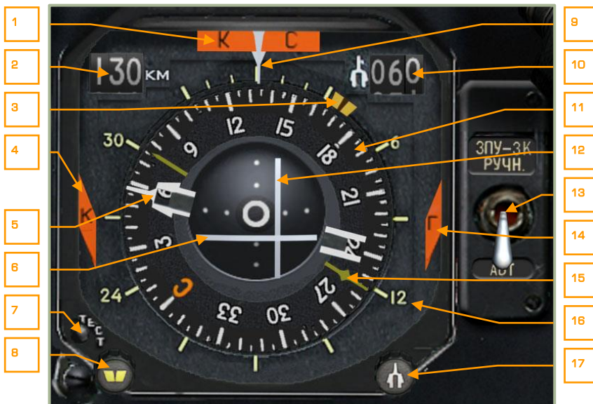
6-12: Прибор навигационный плановый ПНП-72-16
