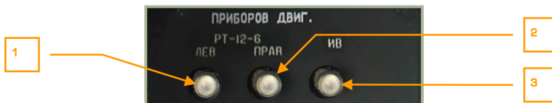
6-64: Панель контроля приборов двигателей
