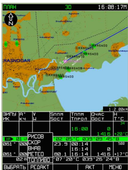
7-70: Выбор функции ввода сведений о наличии топлива ТОПЛИВО
