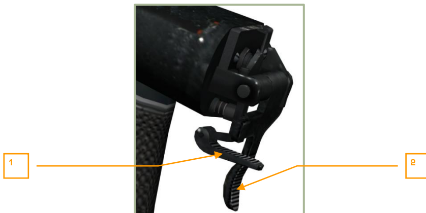
6-5: Гашетки РС и ВПУ в положении ОГОНЬ РС (по умолчанию)
