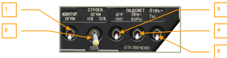
6-59: Пульт правый боковой, панель управления освещением
