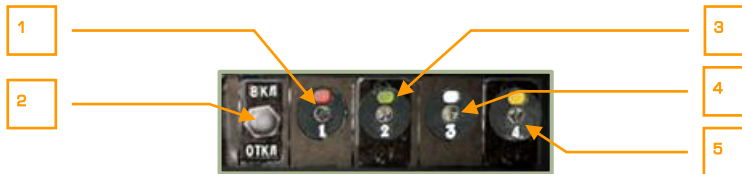
6-49: Пульт управления сигнальными ракетами
