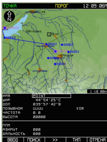
7-118: Выбор типа вводимой точки с помощью кнопки ТИП
