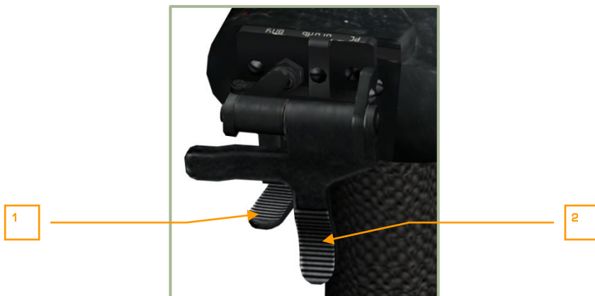
6-6: Гашетки РС и ВПУ в положении ОГОНЬ РС (по умолчанию)
