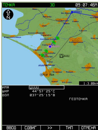
7-111: Ввод типа навигационной точки – ГЕОТОЧКА
