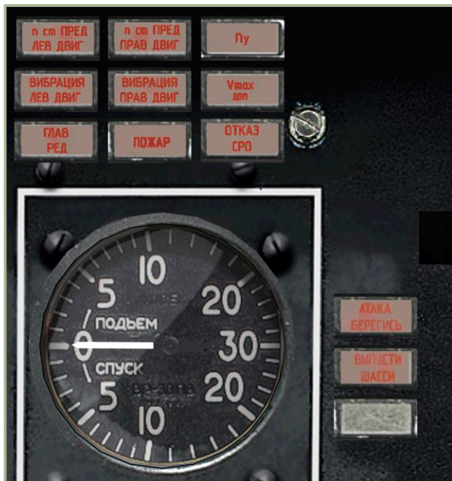
6-28: Табло светосигнальное САС левой приборной доски
