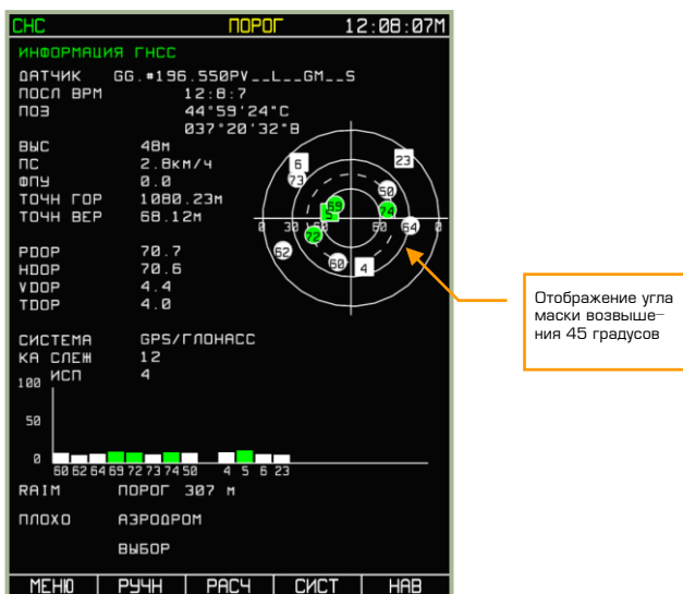
7-32: Вид дисплея при изменении угла маски возвышения
