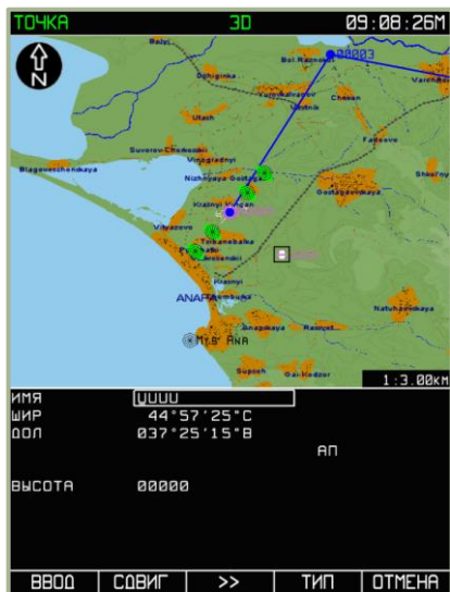
7-112: Ввод типа навигационной точки – АП (АЭРОПОРТ)
