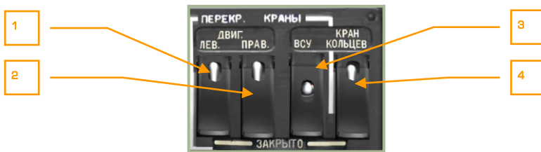
6-56: Пульт правый боковой, панель управления перекрывными кранами
