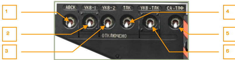
6-53: Пульта правый боковой, панель управления радиооборудованием
