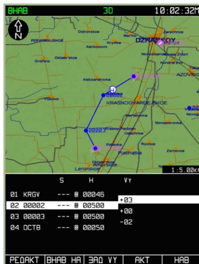
7-102: Рассчитанная точка начала набора высоты при требуемой вертикальной скорости
