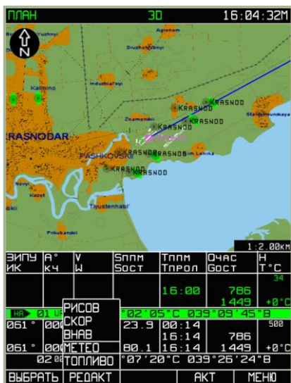
7-66: Выбор функции определения параметров атмосферы по маршруту полета METEO
