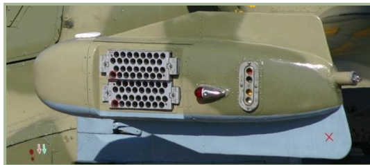
2-9: Устройство выброса ЛТЦ УВ-26. Левый красный АНО и кассета с комплектом сигнальных ракет
