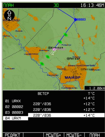
7-69: Результат заполнения значений функции МЕТЕО
