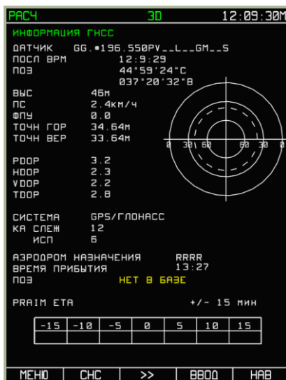
7-36: Сообщение об ошибке позывного аэропорта прибытия при расчете
