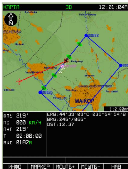
7-22: Вид дисплея при перемещении маркера.
