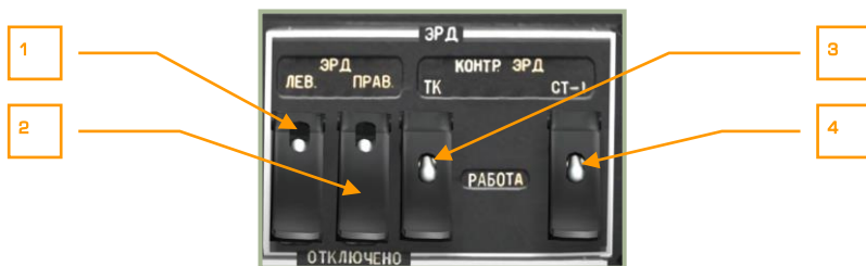
6-60: Пульт правый боковой, панель управления электронными регуляторами двигателей
