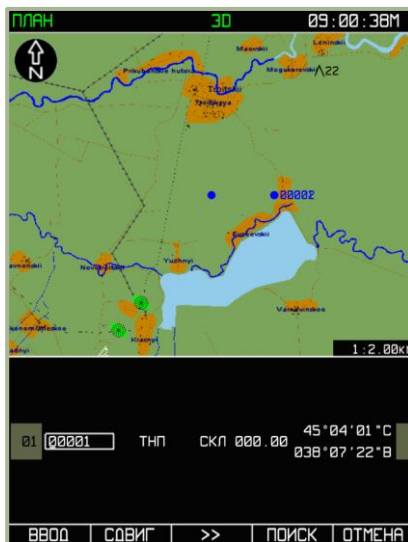
7-49: Страница ПЛАН с доступной функцией ПОИСК
