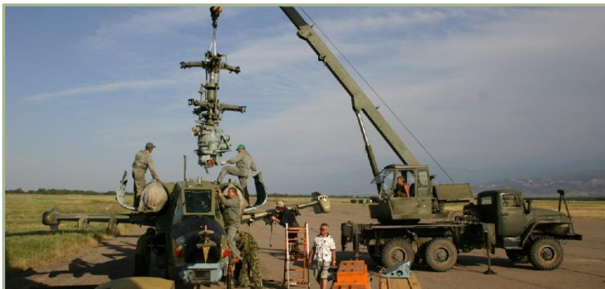
2-4: Установка редуктора в полевых условиях
