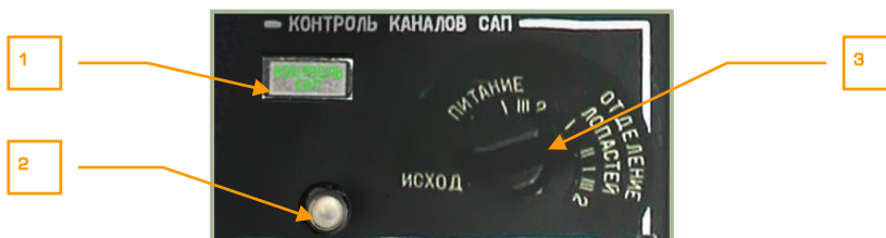
6-65: Пульт контроля каналов САП
