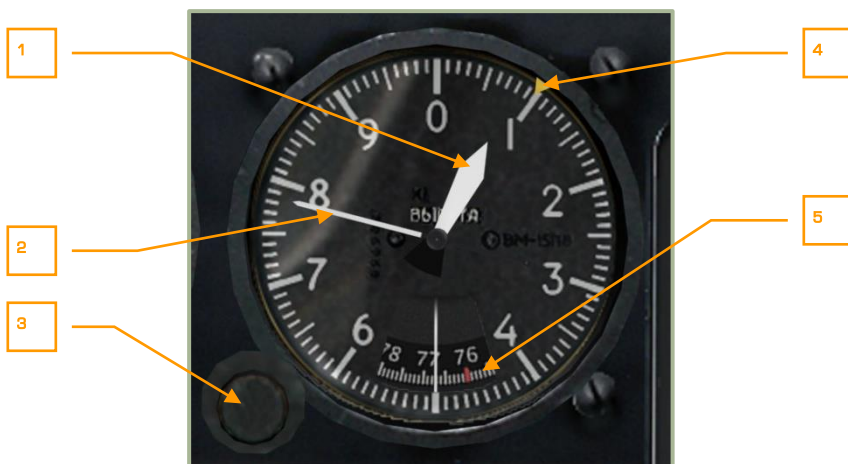
6-15: Высотомер механический BM-15PB
