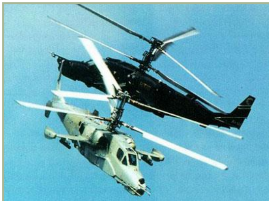
1-10: Вертолёт В-80 №12 (на переднем плане) с макетом ночной прицельной станции «Меркурий» в носовой части
