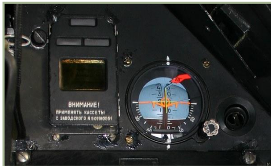
2-5: Система «Экран» (слева) и дублирующий авиагоризонт (справа) в кабине Ka-50
